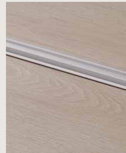
WIELOFUNKCYJNY PROFIL SREBRNY 1860 x 47 x 16 mm Wielofunkcyjny profil Pergo umożliwia łagodne przejście między różnymi rodzajami podłogi o nieznacznej różnicy wysokości. Odpowiedni do różnic wysokości 0–12,3 mm. Powierzchnia: aluminium. PGPRSILV
